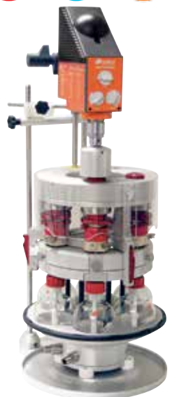
Рабочая станция Breeze, быстрый нагрев/охлаждение.
