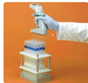
GreenHouse Work-Up совместима со стандартными многоканальными диспенсерами.
